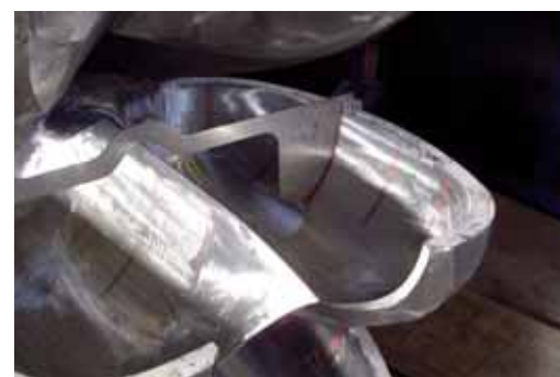
Girante Pelton - Fase di Controllo Dimensionale Pelton Runner - Dimensional Check
