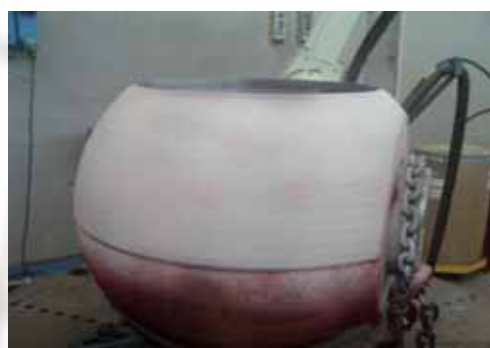
Controllo Liquidi Penetranti su Saldatura grezza Dye Penetrant Test on surface "as welded"
