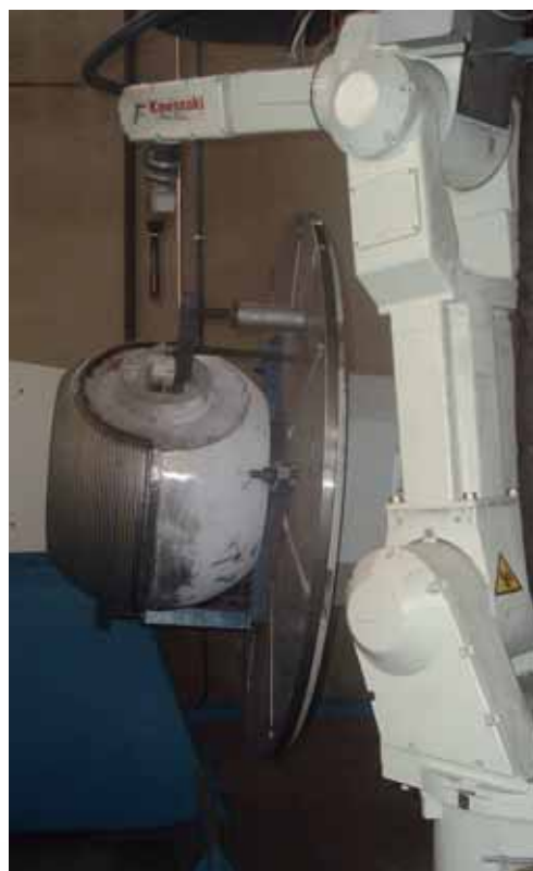
Sfera 20" - Test per Riporto Inconel 625 - Procedimento a Filo Ball 20" - Inconel 625 Overlay Test - GMAW Process
