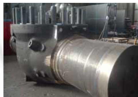
Saldatura di Giunzione Corpo/Tronchetto/Economizer Procedimenti GTAW+GMAW+SAW Butt Joint Body/Pups/Economizer - GTAW + GMAW + SAW Process
