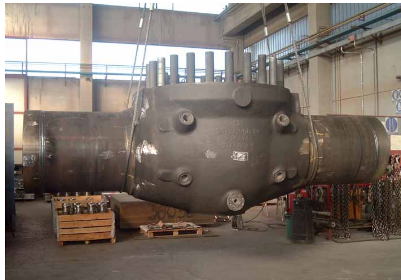
Corpo Valvola Top Entry 38" 900 - Overlay totale Inconel 625 - Procedimento Filo GMAW Saldatura di Giunzione Corpo/Tronchetti - Procedimenti GTAW + GMAW + SAW Saldatura di Giunzione Tronchetti/Economizer - Procedimenti GTAW + GMAW + SAW Body Top Entry 38" 900 - Inconel 625 Full Overlay - GMAW Process Butt Joint Body/Pups - GTAW + GMAW + SAW Process Butt Joint Pups/Economizer - GTAW + GMAW + SAW Process
