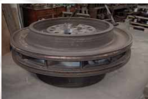
Girante Francis - Ripristino con Riporto in Inox 13/4 Francis Runner - Regeneration Inox 13/4 Overlay
