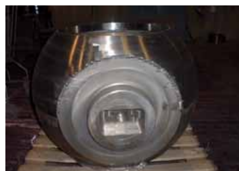
Sfera Lavorata parzialmente Partial Machining
