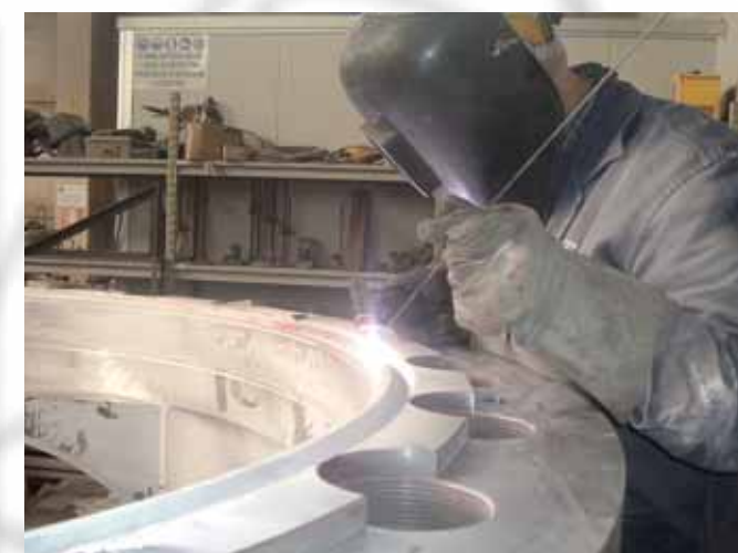
Riparazione - Procedimento GTAW Repair - GTAW Process
