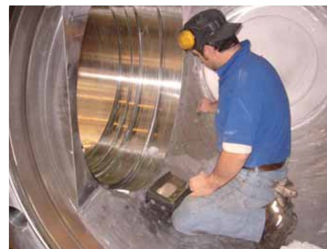
Controllo Ultrasuoni Ultrasonic Test
