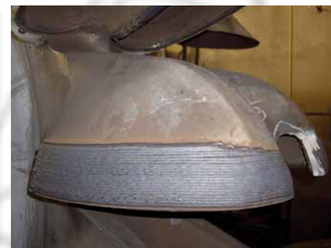
Dettaglio Riporto Zona Scarico Back side Overlay detail
