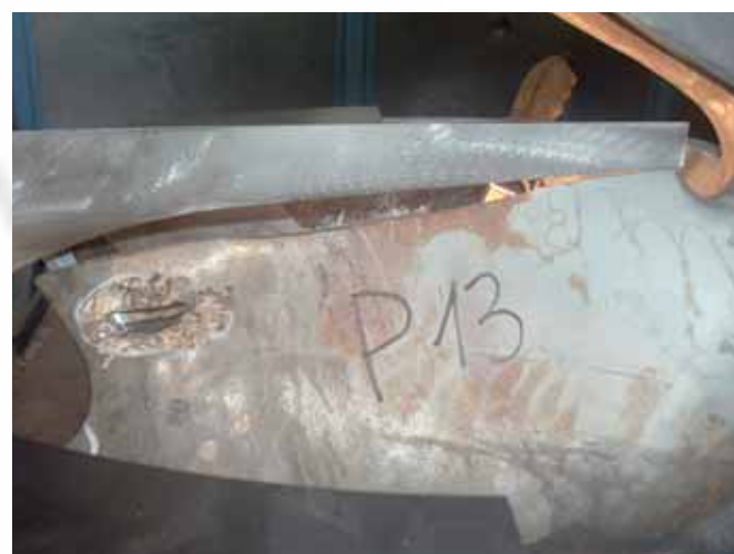
Dettaglio Erosione Coltello Splitter Erosion Detail
