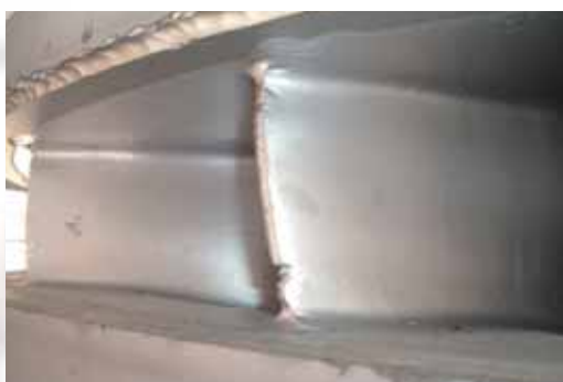
Girante Francis - Evidenza di erosione Francis Runner - Erosion Detail
