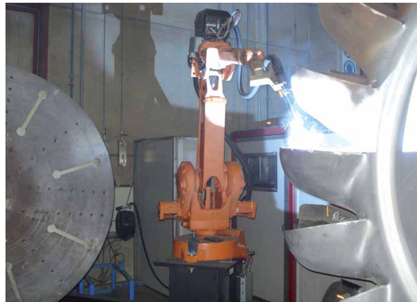
Girante Pelton - Ripristino dimensionale completo delle zone attive con Riporto in Inox 13/4 - Procedimento GMAW robotizzato Pelton Runner - Complete regeneration of active hydraulic zone with Stainless Steel 13/4 Overlay - GMAW process with Robot
