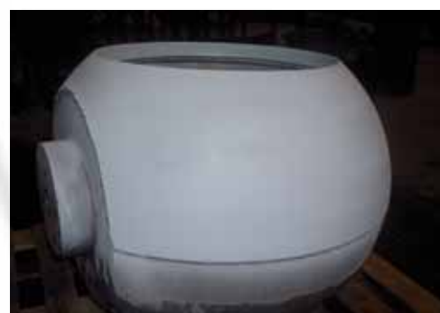
Liquidi Penetranti su Saldatura dopo Lavorazione Meccanica Dye Penetrant Test on machining surface
